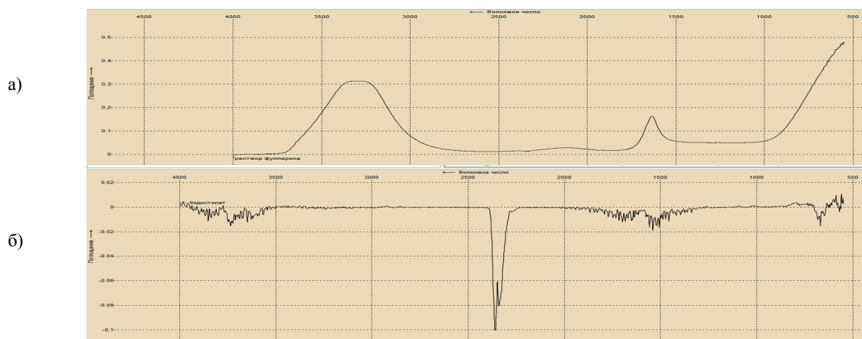
Рисунок 3. а) ИК-спектр фуллерена C_{60} без вычета опорного спектра бидистиллята, б) ИК-спектр фуллерена C_{60} с вычетом опорного спектра бидистиллята
