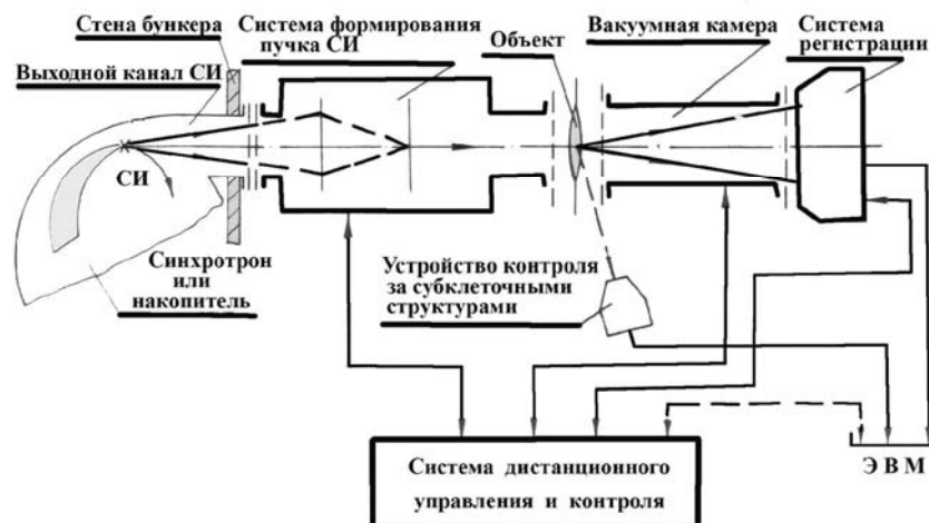
Рисунок 1. Блок-схема рентгendifракционных станций на источниках СИ на основе методов монокроматической и энергетической дифрактометрии
