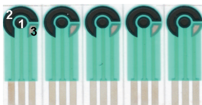
Рисунок 1. Планарная электродная система: 1 – рабочий электрод, 2 – вспомогательный электрод, 3 – электрод сравнения
