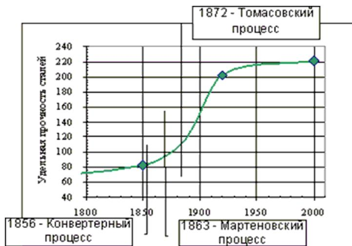
Рисунок 1. Зависимость удельной прочности сталей от времени
