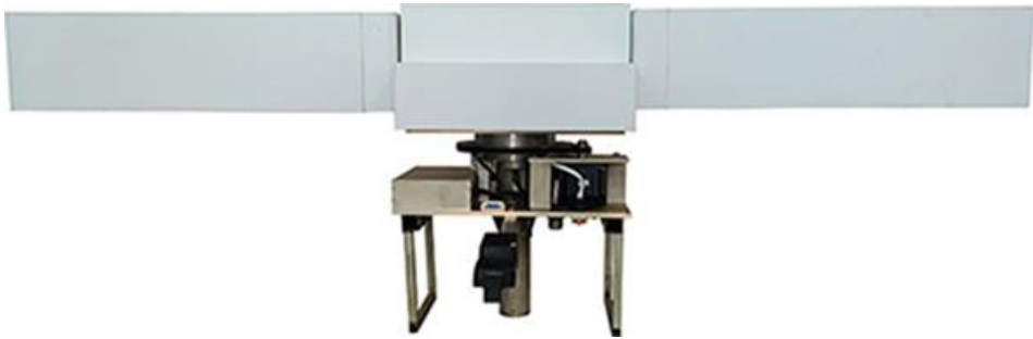
Рис. 5. Внешний вид радара FMCW.
