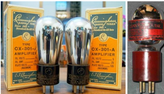
Рис. 7. Радиолампы: 0,1A/CX-301-A CUNNINGHAM (Short Base). Made in USA by RCA (слева) и Raven MU-20 (Serial 61376) (справа).
