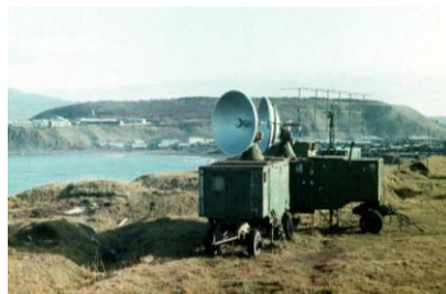
Рис. 4. Станции обнаружения и пеленгования корабельных РЛС 10-см диапазона на расстоянии до 500—1000 км
