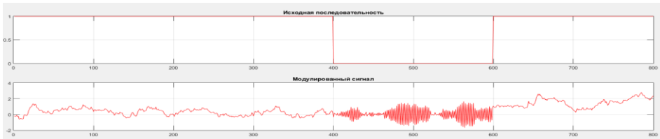
Рис. 4. Последовательность бит на передатчике и результат модуляции Fig. 4. Transmitter bit sequence and modulation result
