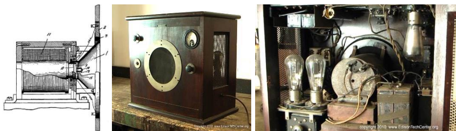
Рис. 8. Конструкция электродинамического громкоговорителя Честера Райса (по патенту US1707570) и радиола Model 104 с этим громкоговорителем мощностью 1 Вт [7]. 1926 г.
