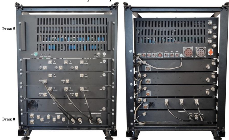
Рис. 7. Фото внешнего вида передней (а) и задней (б) панелей стойки основного блокиратора JAGUAR.
