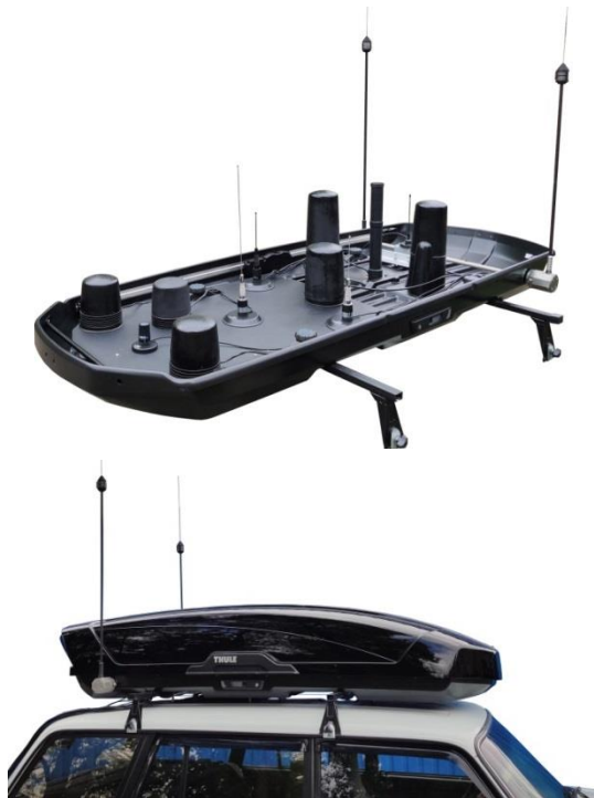
Рис. 9. Фото внешнего вида антенного поля блокиратора JAGUAR, размещенного в автобоксе Thule и общий внешний вид автомобиля с установленной антенной системой.
