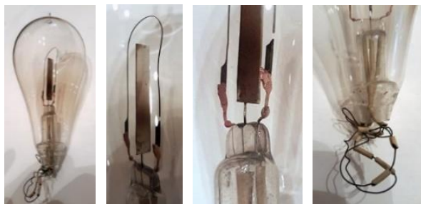
Рис. 19. Лампа с эффектом Эдисона, сделанная в 1885 г. для профессора Флеминга [22].
