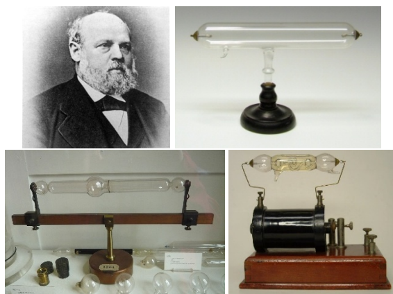
Рис. 5. Иоганн Гейсслер, его газоразрядные трубки различной конструкции (конец XIX в.) и подключение трубки к катушке Румкорфа. Fig. 5. Johann Geissler, his gas-discharge tubes of various designs (late 19th century) and the connection of the tube to the Rumkorff coil
