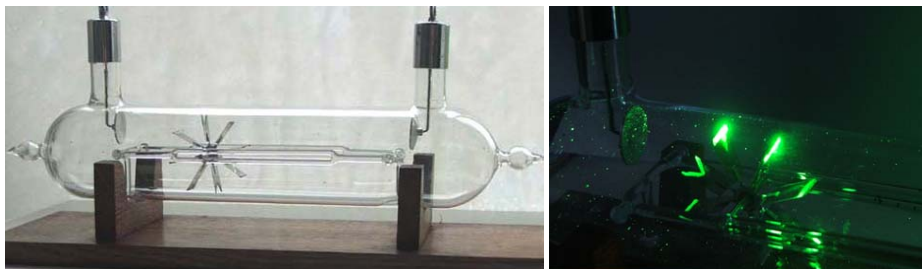
Рис. 16. Эксперимент Уильяма Крукса: движение «ребенчатого колеса» под действием катодных лучей. Справа показаны флуоресцентные наконечники на лопастном колесе, светящиеся от электронной бомбардировки при её приближении к аноду. 17
