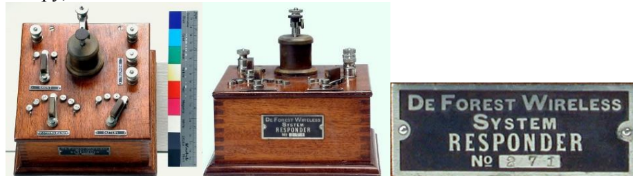
Рис. 16. Общий вид радиоприемника Responder (De Forest–Smythe). 1903 г. [27].
