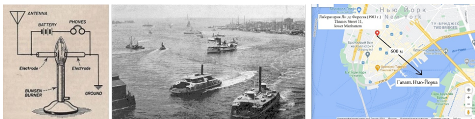
Рис. 4. Принципиальная схема радиоприемника Ли де Фореста с бунзеновской горелкой и гальванической батареей, на который принимались сигналы с кораблей в гавани Нью-Йорка (1893 г.). Карта района Нью-Йорка, показывающая расположение лаборатории Ли де Фореста (1903 г.) и гавани, откуда принимались сигналы беспроводной телеграфии.
