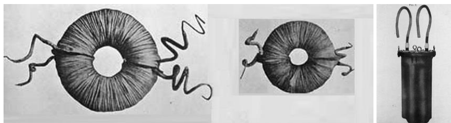
Рис. 12. Образцы загрузочных катушек. Футляр с загрузочной катушкой. 1904 г. [32].
