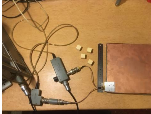
Рис. 7. Подключение микрополосковых структур к измерителю.
