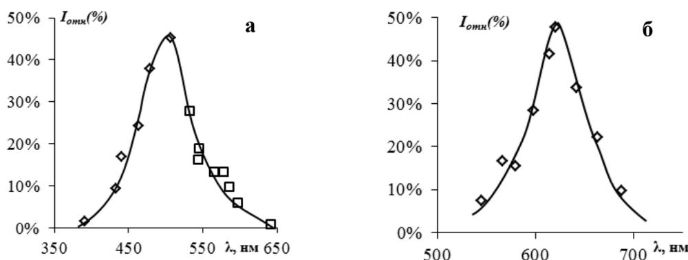
Рисунок 3 – Спектры ХЛ при лакказном окислении фенолов.  $[E]_0 = 50$  мг/л, цитратный буфер pH 4,6, T 308 K, а) флороглюцин:  $[S]_0 = 0,1$  mM,  $\lambda_{max} = 496 \pm 25$  нм; б) галловая кислота:  $[S]_0 = 0,25$  mM,  $\lambda_{max} = 622 \pm 12$  нм
