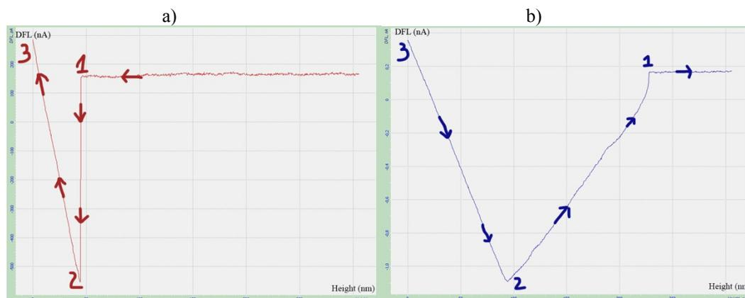
**Рисунок 1.** Примеры кривых DFL(Height) в режиме «подведение» (a) и «отведение» (b) кантилевера. По оси абсцисс показана высота (Height), измеряемая в нанометрах. По оси ординат – значение вертикального отклонения кантилевера (DFL), измеряемая в наноамперах
