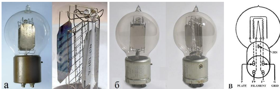
Рис. 16. Общий вид ламп типа: М — 101А (а), L — 101В (б) и их устройство (в). 1915 г.
