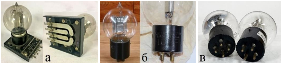
Рис. 17. Радиолампы WEC под названием «теннисный мяч» типа: 101D (а) с ламповой панелькой 100-L, 101F (б) и цоколевка ламп 101D и 101F (в).
