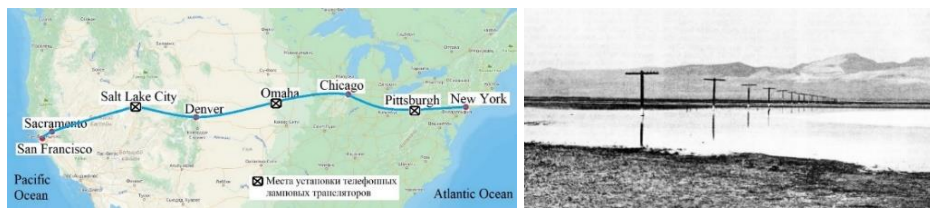
Рис. 2. На карте отмечены города США, которые связала трансконтинентальная телефонная линия связи в 1915 г. На карте показаны места установки первых трех телефонных ламповых трансляторов (январь 1915 г.). Трасса трансконтинентальной телефонной линии через соленое озеро Гумбольдта на северо-западе штата Невада (1700 миль от Сакраменто).
