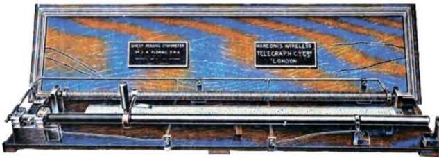
Рис. 3. Общий вид промышленной конструкции волномера (цимометра) Дж. А. Флеминга. 1904 г.
