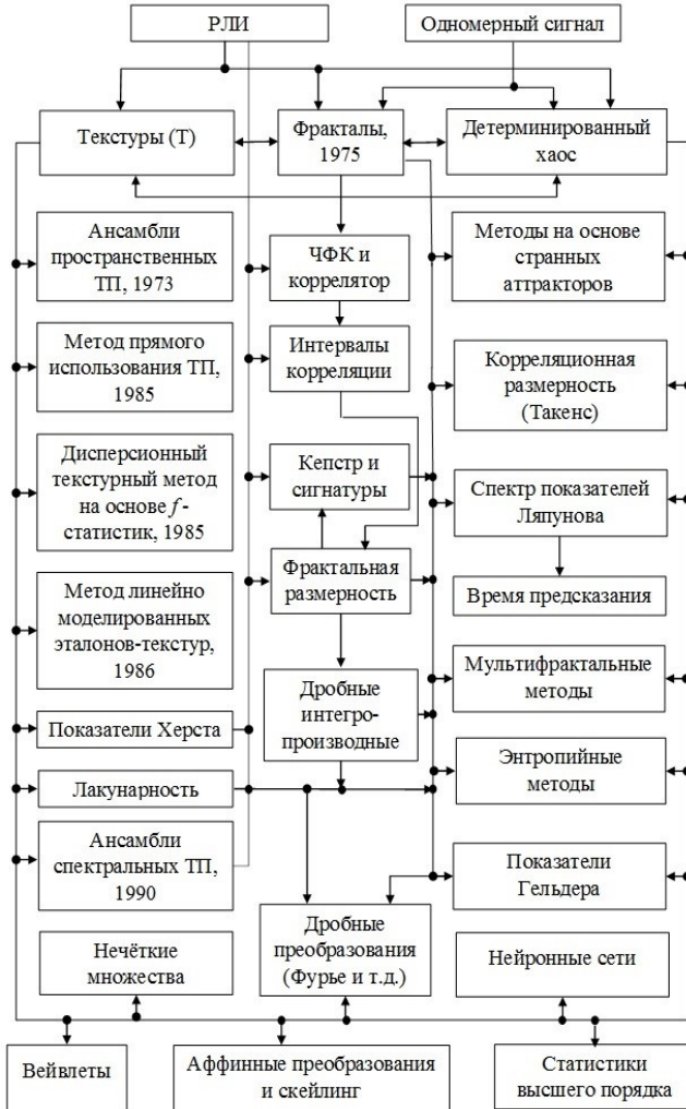
Рис. 5. Новые топологические признаки и методы обнаружения малоконтрастных объектов на фоне помех (ТП — текстурные признаки, ЧФК — частотная функция когерентности, РЛИ — радиолокационное изображение).
