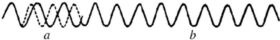
Рис. 13. Измеренные осциллограммы временной зависимости (а) переменного тока электростанции Страсбург, (б) колебания камертона [19].
