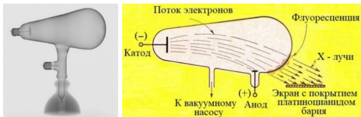
Рис. 9. Общий вид катодной трубки Рентгена в первых его экспериментах и эксперимент, объясняющий открытие X-лучей (1895 г.) [11]
