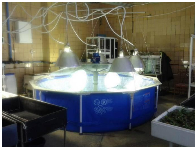
Рисунок 2 – Общий вид промышленного газовихревого фотобиореактора, объём 580 л.
