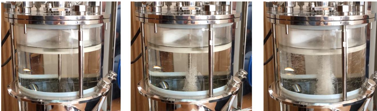
Рисунок 1 – Общий вид лабораторного газовихревого фотобиореактора, объём 5 л. Показан образующийся вихрь в суспензии
