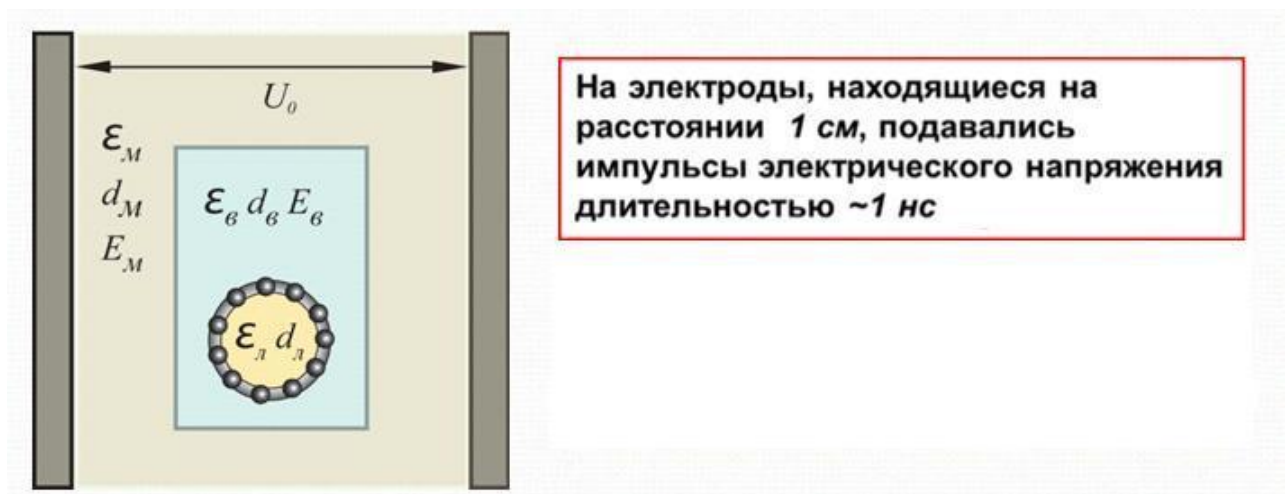
Рисунок 2 – Схема эксперимента по воздействию импульсного электрического поля на суспензию нанокомпозитных липосом
